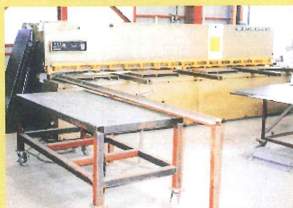
■シャーリング 最長切断長さ4m
